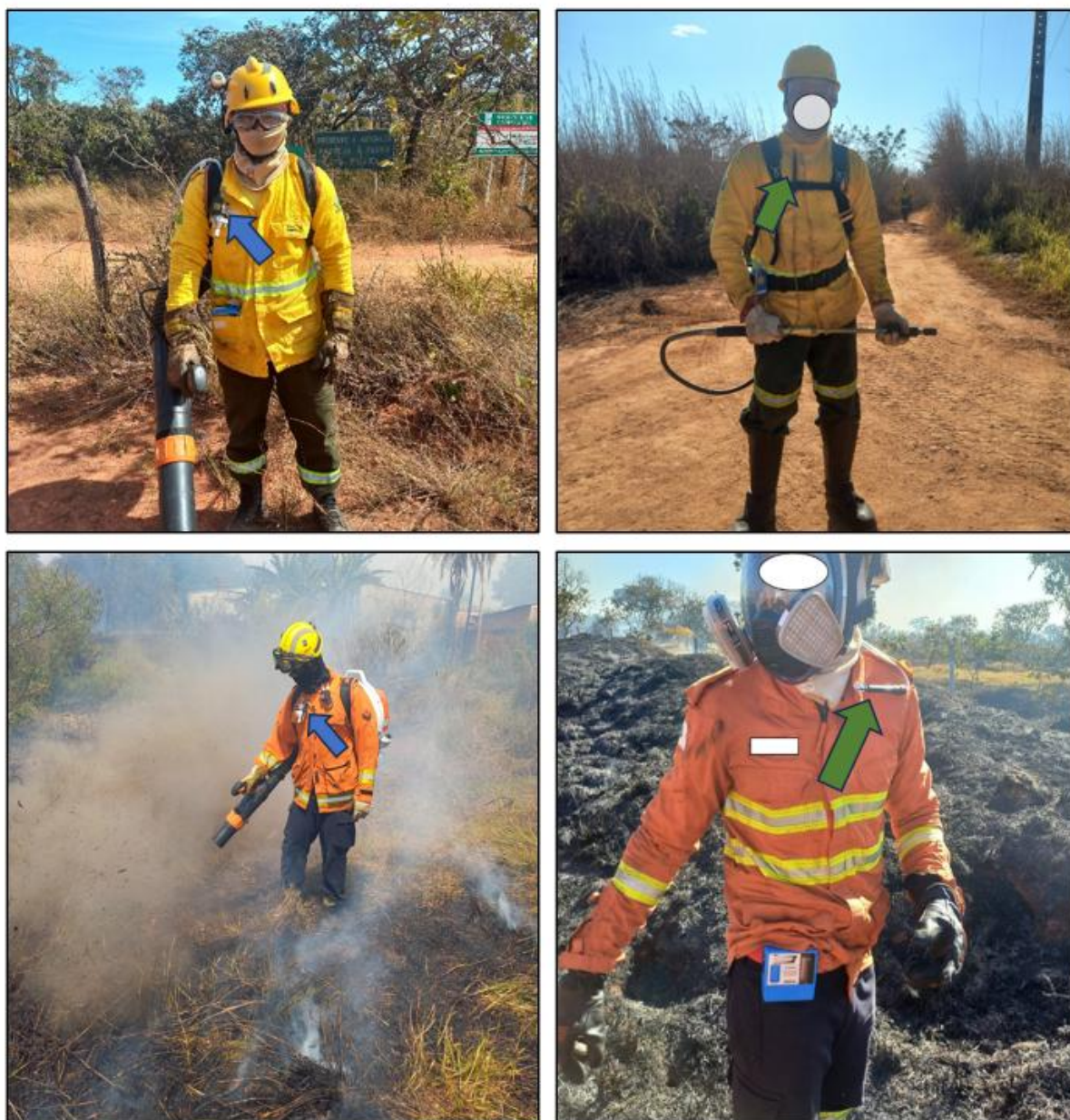
Figura 1. Brigadistas (superiores) e bombeiros (inferior) utilizando soprador com suportes de ciclone para coleta de material particulado (azul) e tubos de adsorção para compostos orgânicos (verde).
