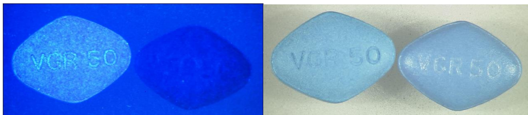
Figura 22. Comprimidos à esquerda observados na região ultravioleta e a direita na região do visível (Direita autênticos e esquerda falsificados). Observamos divergências na cor e no comportamento químico do revestimento dos comprimidos sob radiação ultravioleta.
